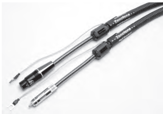
ラインケーブル7NAC-Grandio07の端子はRCAとXLRの両方を用意。外側シールドから引き出されたアース端子は、出力側機器のアースに接続する
