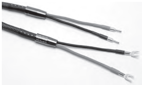
スピーカーケーブル7NSP-Grandio07は直径16mmで、赤と黒の平行線で構成されている。アース線は引き出されていない
